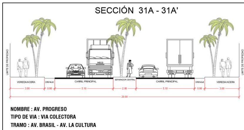
Imagen 31. SECCIÓN VIAL 31A – 31A – VÍA COLECTORA
